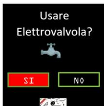
In tutti i casi quando la modalità manuale è selezionata si può scegliere se utilizzare la valvola di scarico o meno. Se si sceglie "sì" sarà abilitato il tasto "stop\menu" per interrompere l'erogazione e scaricare la pressione residua.
